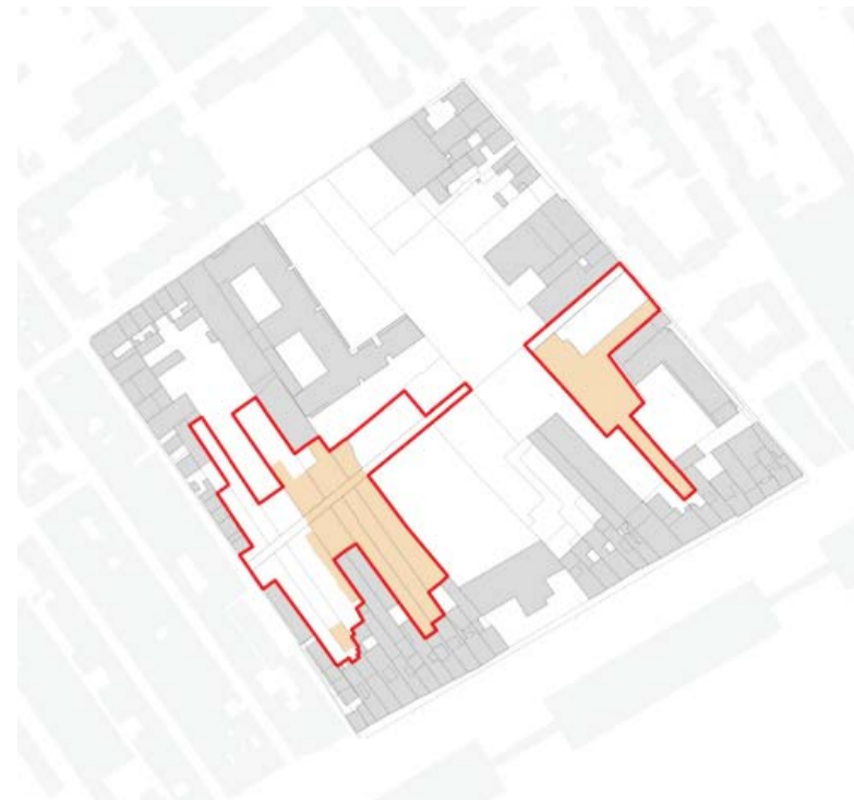
DÉFINIR UN PÉRIMÈTRE D'OPÉRATION_ CURETER LE BÂTI DÉGRADÉ_
